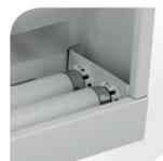
Lâmpada Fluorescente Tubular. Corpo em chapa de aço tratada e pintada. Refletor facetado em alumínio anodizado brilhante de alta refletância e alta pureza 99,85%. Soquete tipo push-in G-13 de engate rápido, rotor de segurança em policarbonato e contatos em bronze fosforoso. Instalação de sobrepor.
