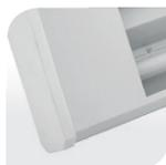
Lâmpada Fluorescente Tubular. Corpo em chapa de aço tratada e pintada. Refletor em chapa de aço tratada e pintada. Difusor em poliestireno plano transparente. Soquete tipo push-in G-13 de engate rápido, rotor de segurança em policarbonato e contatos em bronze fosforoso. Instalação de sobrepor.
