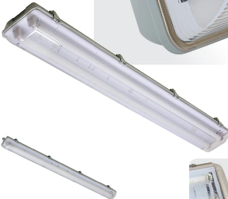
Lâmpada Fluorescente Tubular. Corpo em policarbonato cinza. Difusor em policarbonato transparente texturizado. Soquete tipo push-in G-13 de engate rápido, rotor de segurança em policarbonato e contatos em bronze fosforoso. Instalação de sobrepor.
